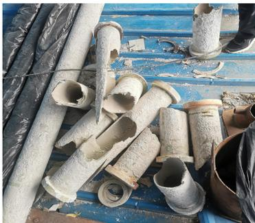
断管：主要在距离法兰30-60cm处出现断管
